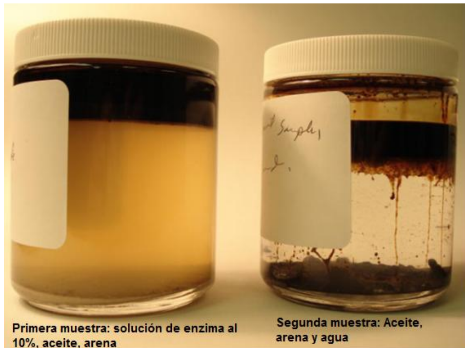
Figura 23. Resultados de pruebas de botella realizadas en EEUU con enzima biológica.
